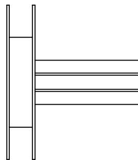
PVC točak, doboš za namotavanje rolo trake sa kućištem za kuglični ležaj Ø 28 mm.
