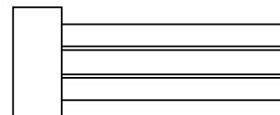
PVC završetak na osovinama Ø 40, Ø 60, Ø 70 mm, sa kućištem za kuglični ležaj Ř 28 mm.
